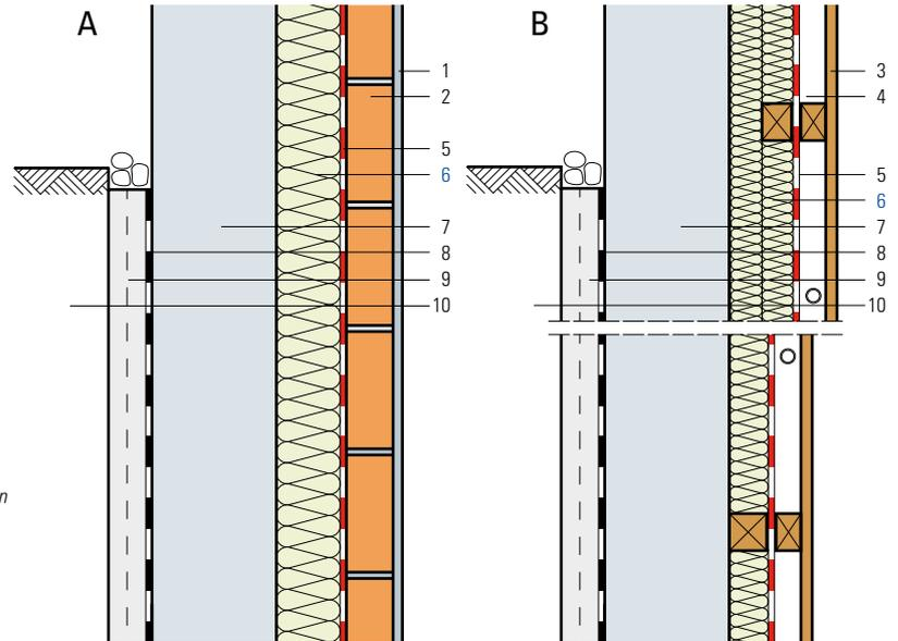
*Bauphysikalisch ungünstige Bauweise aufgrund grosser Wärmebrücken im Bereich der Bauteilanschlüsse!*
