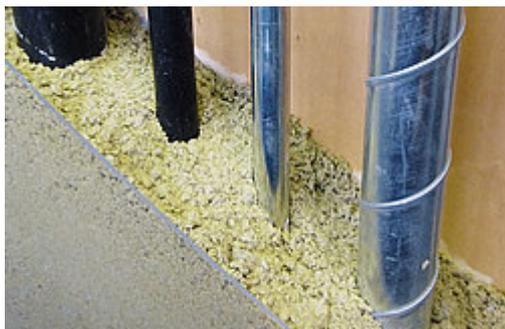
Lose Steinwoll-Flocken für den Einsatz in Installationsschichten, schwer erreichbaren Stellen oder zum Füllen von Hohlräumen jeglicher Art. Kann auch mit geeigneten Einblasmaschinen verarbeitet werden.
