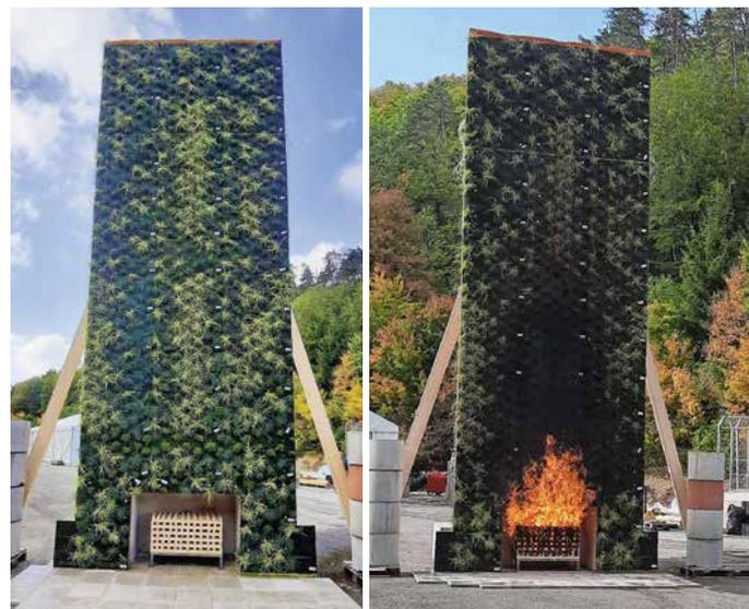
La nouvelle structure de façade avec substrat de laine de pierre a répondu aux attentes dans le cadre des tests de protection incendie.
