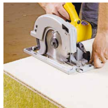
Einfaches Zuschneiden mit der Handkreissäge
