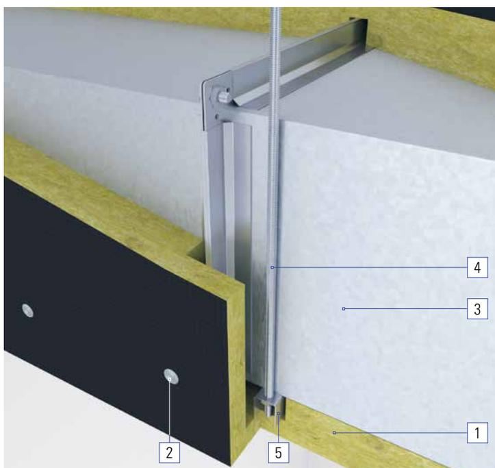
Im Bereich von Kanalverbindungen und Abhängungen kann Conlit Ductboard LW bis zu einer Tiefe von 30 mm ausgeklinkt werden, ohne dass eine zusätzliche Aufdopplung erforderlich wird. Die genauen Ausführungsdetails sind den nachfolgend aufgeführten Abbildungen zu entnehmen.
