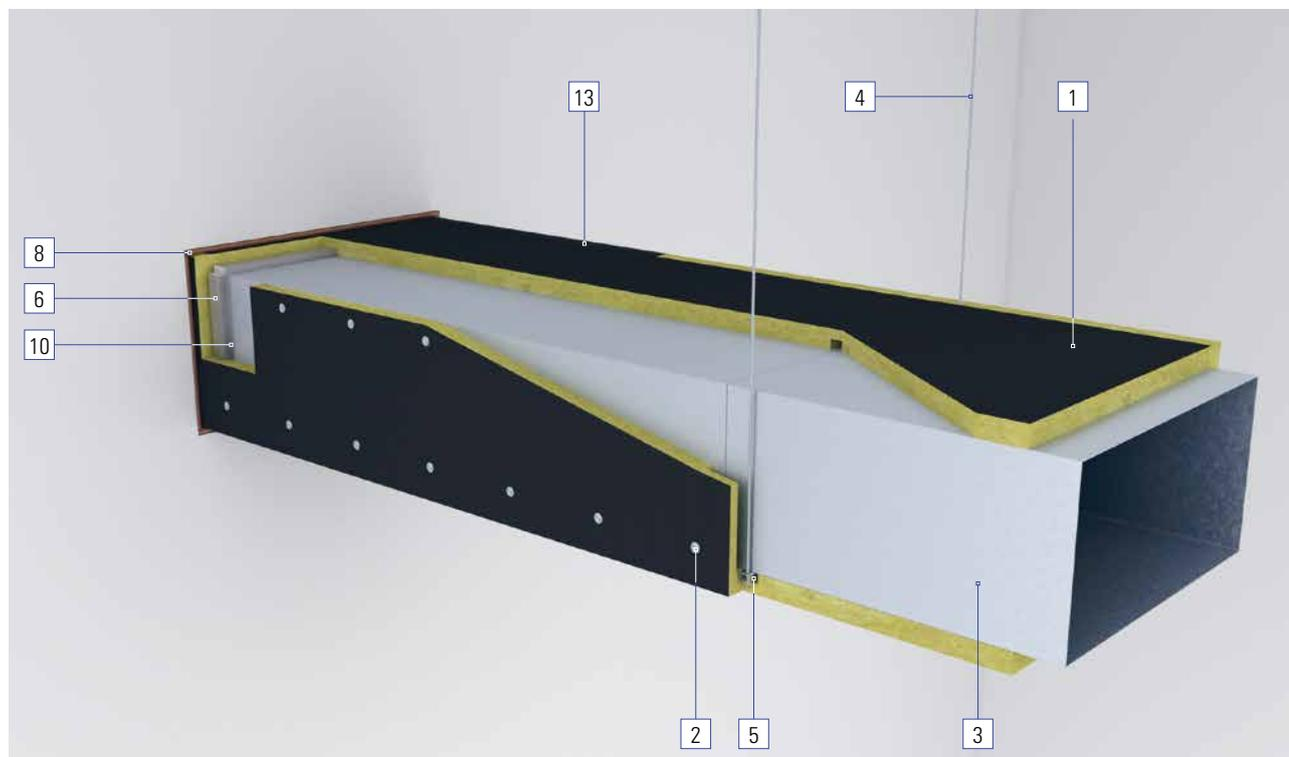
Die Verarbeitung von Flumroc Conlit Ductboard LW ist bemerkenswert einfach. Als einlagiger Aufbau wird die Dämmung direkt am Kanal appliziert und erlaubt mit dem geringen Bekleidungs-gewicht schlanke Aufhängungen.
