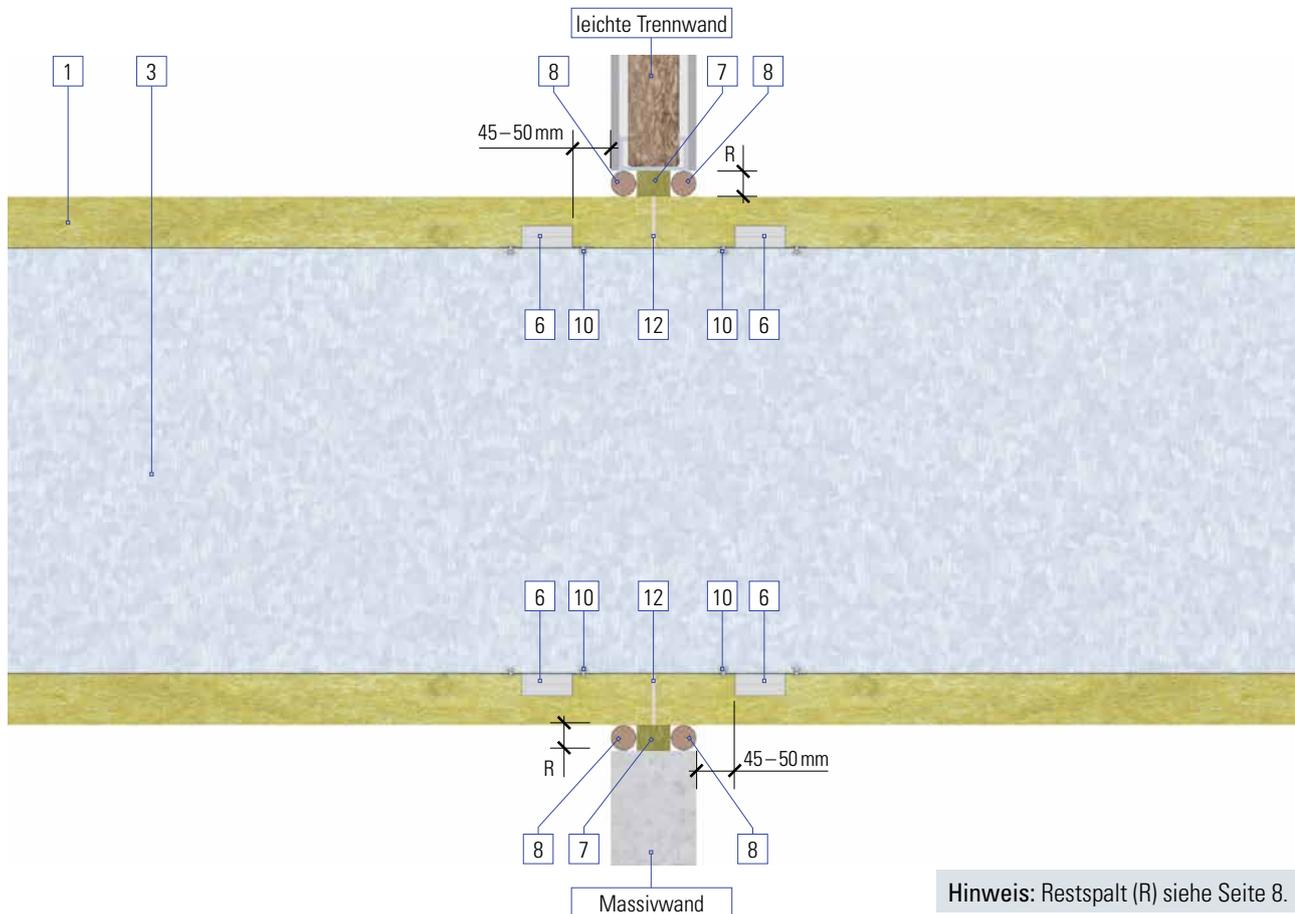
Die Brandschutzbekleidung wird auf der Lüftungsleitung durch die Wandöffnung geführt. Ein vollflächig mit Conlit Fix verklebter Plattenstoss ist in der Wandmitte anzuordnen und sichert die Rauchdichtigkeit im Brandfall. Die Kanalverstärkung Flumroc Conlit DRP wird umlaufend, im Abstand von 45–50 mm beidseitig zur Wand, montiert. Dieses Profil wird direkt auf den Stahlblechkanal genietet.
