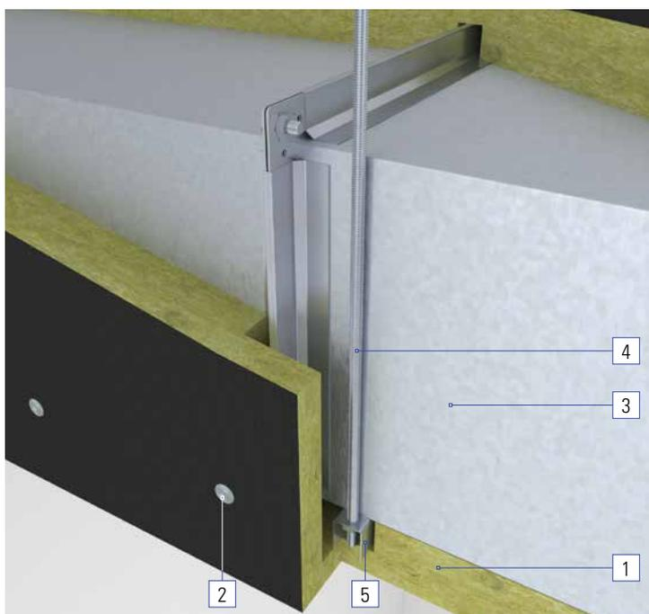
Im Bereich von Kanalverbindungen und Abhängungen kann Conlit Ductboard LW bis zu einer Tiefe von 30 mm ausgeklinkt werden, ohne dass eine zusätzliche Aufdoppelung erforderlich wird. Die genauen Ausführungsdetails sind den nachfolgend aufgeführten Abbildungen zu entnehmen.
